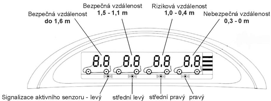
Minimální zobrazovaná vzdálenost je 0,3 metru od překážky. Pokud je vozidlo blíže, je již zobrazována hodnota 0,0. Hlasitost akustické signalizace lze nastavovat ve dvou úrovních pomocí přepínače na zadní straně displeje. **High** – vyšší úroveň hlasitosti, **Low** – nižší úroveň hlasitosti.
