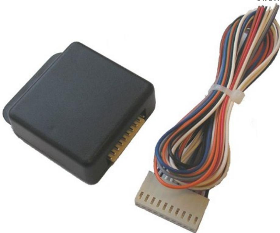
Modul je určen k připojení na datové rozhraní CAN-BUS v motorových vozidlech s palubním napětím 12V a ukostenřeným mínus pólem. Modul převádí digitální informace na analogové, za účelem propojení se vstupy autoalarmů Athos, Akcent a dalších.
