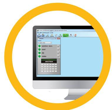
Pokud je v systému použita klávesnice s alespoň jedním ovládacím segmentem, pak je možné zajišťovat / odjišťovat z J-Linku na virtuální klávesnici (dostupná z Hlavního menu tlačítkem „Klávesnice“).
